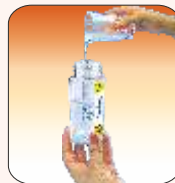
3. Pour water sample upto 100ml mark
