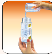
3. Pour water sample upto 100ml mark
