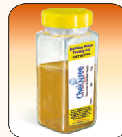
3. Pour water sample upto 100ml mark
