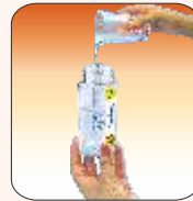
3. Pour water sample upto 100ml mark
