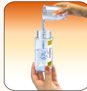
3. Pour water sample upto 100ml mark
